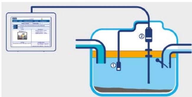
Abb. 2: Leichtflüssigkeitsabscheider mit erweitertem Überwachungssystem „Continuous Online Monitoring System“ (COMS) [6]
