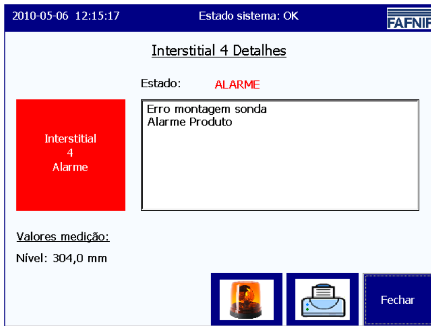
Figura 17: vista detalhada da sonda Interstial 4 com estado de alarme
