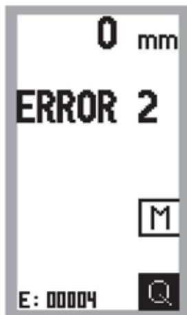
Figura 22: Indicación "Error", código de error 2: Interrupción
